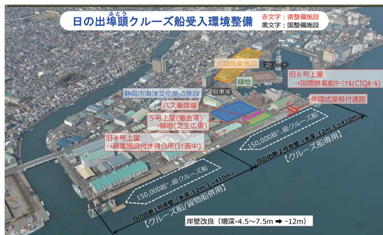
日の出埠頭クルーズ船受入環境整備。岸壁2バース(延長820m、水深-12m)の整備により2隻同時接岸が可能に
