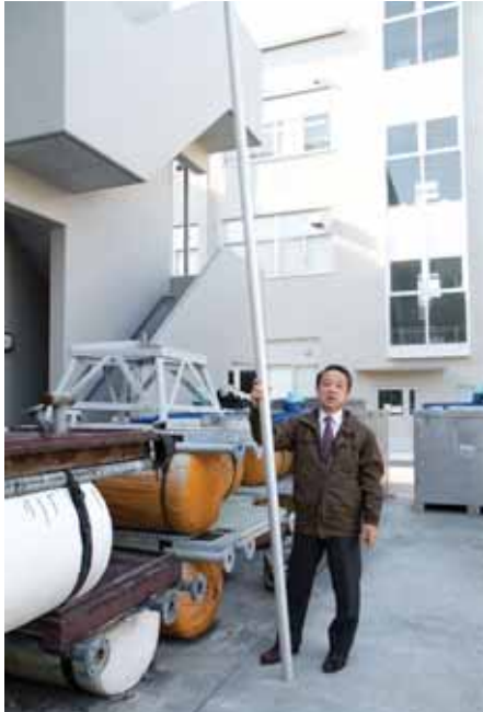
試料採取のパイプは、長さ21～24mの筒状でアルミ、またはアクリル製です。いかだの上から湖底にパイプを突き刺し、柱状の試料を採取します。試料1本から3000年間の津波の歴史がわかるそうです
