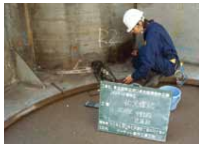
レグトップにおける超音波探傷結果の確認状況
