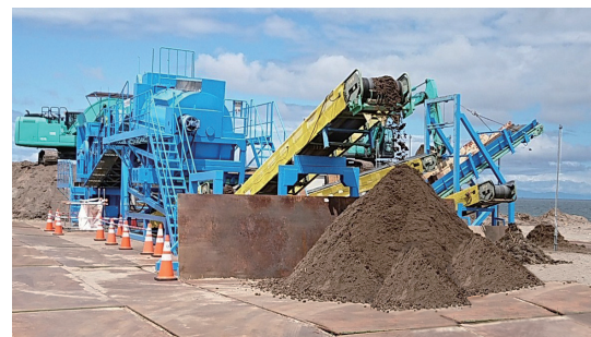
土砂分別機による表土の分別状況
