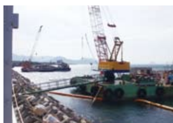
◀薬注プラントを搭載したクレーン付台船
