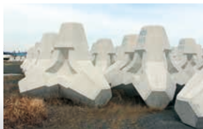
製作された消波ブロック
