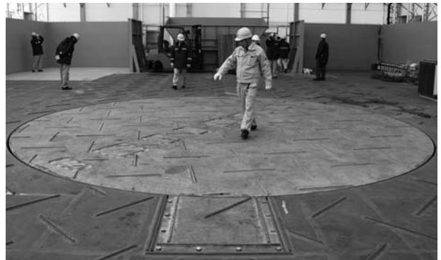
▲投入台船内部、ターンテーブル
