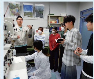
地盤力学特論（大学院）での要素試験（異方圧密下での繰返し載荷）
