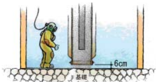
図3 打設当初の理想的なケーシングすきまは6cm
