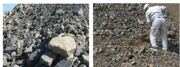
図-2 土砂処分場護岸に用いた岩ズリ(採取場)
