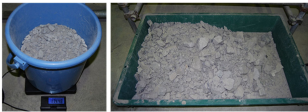
図-4 粒度調整後の岩ブリ(左側 0~20mm, 右側 0~100mm)
