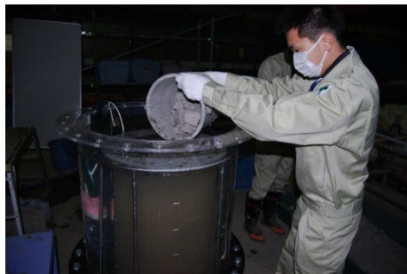
図-13 岩ズリ水中落下状況
