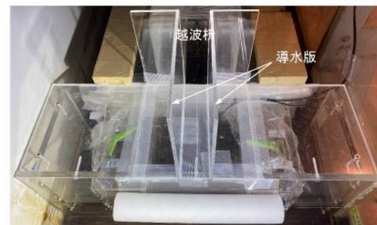
図-3.1.6 係留索に作用する張力および越波量の計測
