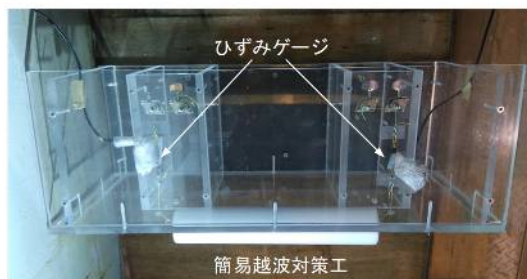
図-3.1.6 係留索に作用する張力および越波量の計測
