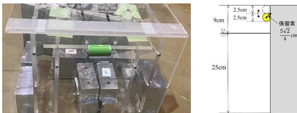
図-3.3.3 係留式越波対策工模型および水深、天端高と設置位置の関係
