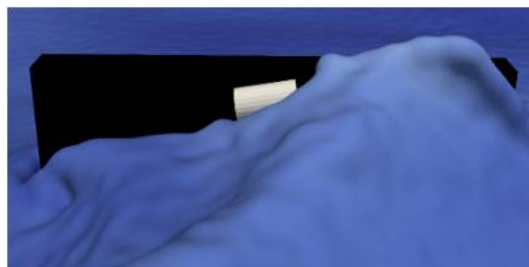
図-4.5.6 対策工に斜め入射波が作用する様子
