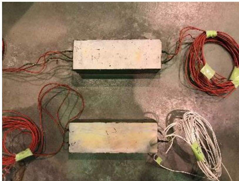
写真-4.1 角型供試体 (上：無防食供試体, エポキシ鉄筋 下：防食供試体)
