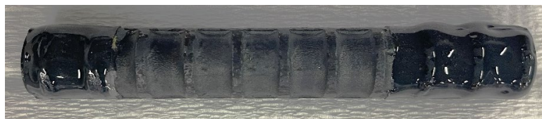
図 3.2 鉄筋両端をエポキシ樹脂接着剤で被覆した様子
