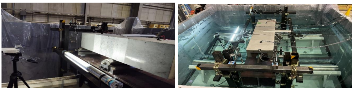
図-10 空気中（左写真）および水中（右写真）における試験体設置の様子
