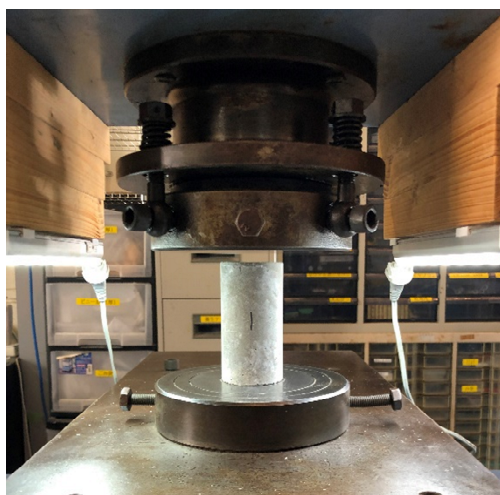
写真-4.4 圧縮強度試験の様子
