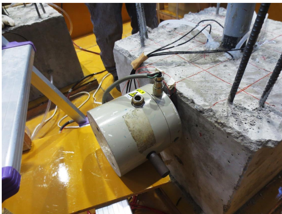
写真-2.5 コンクリート縦振動試験の様子
