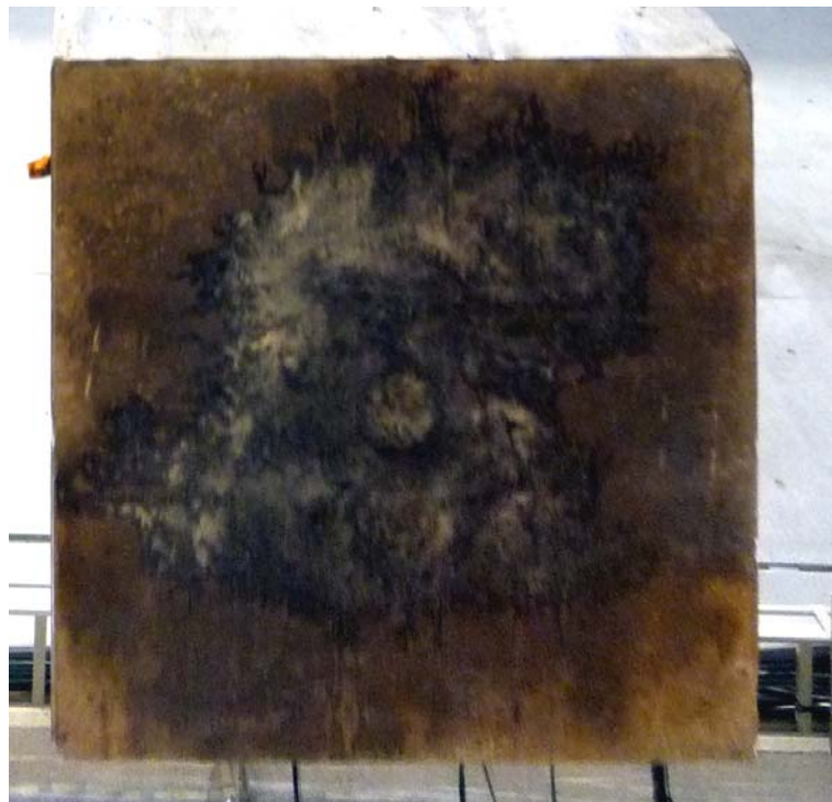
写真-3.4 HK100 供試体 腐食率 38.5% 底面
