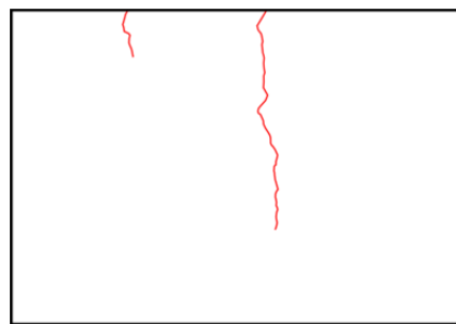
換算腐食率 38.5% 西面 (積算電流量 206.0Ah)
