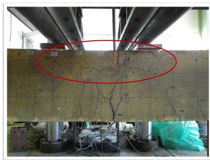
図 4-3 最大荷重作用時,側面
