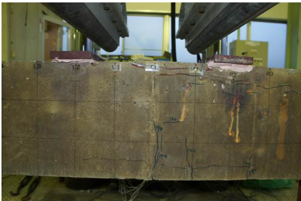
図 4-9 最大荷重作用時,側面
