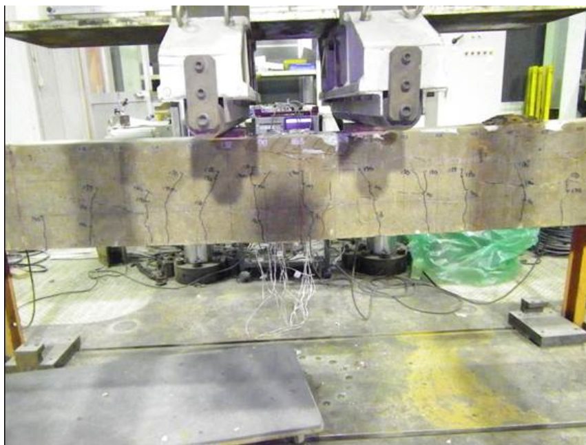
図 4-7 最大荷重作用時,側面
