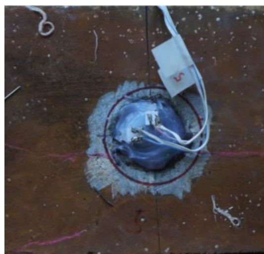
供試体底部ひび割れ状況
