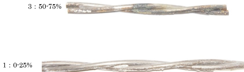
図 6-20 腐食状況目視評価例
