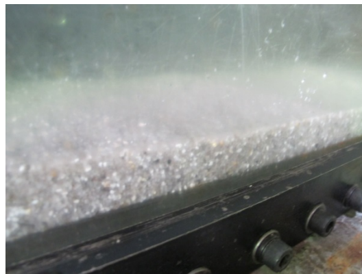
図-3.4 下部排水層の設置（珪砂 3 号）
