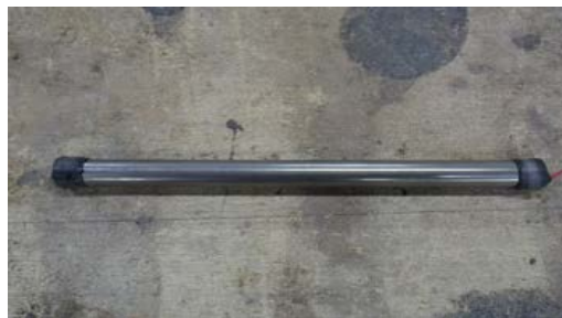
写真－2 前処理後の鋼材
