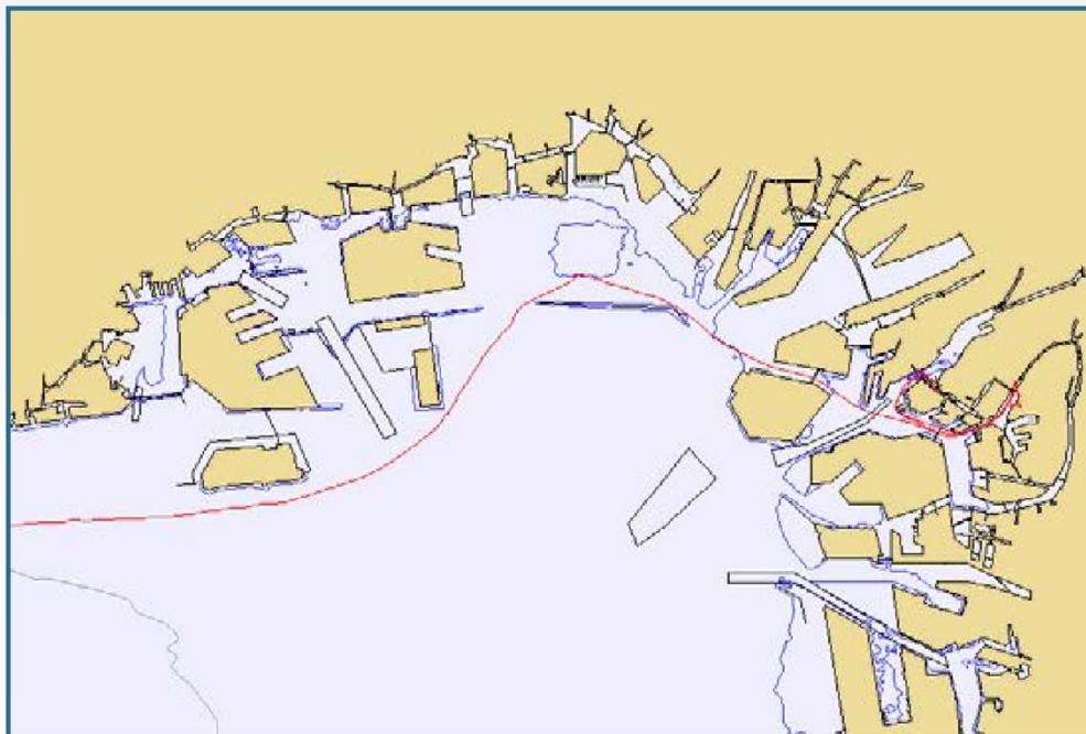
図4 作業船Class-B AISの航跡例
