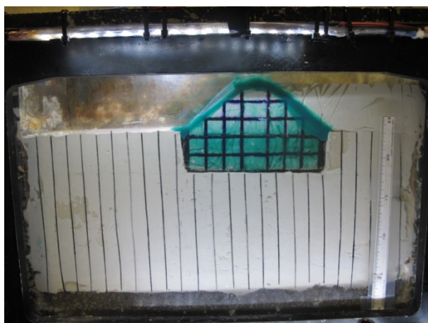
図-3.12 遠心模型実験装置にセット試料容器と模型地盤
