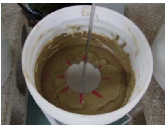
図 14 円柱を回転させた場合の地盤の様子
