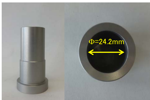
図 24 回転粘度計で用いた容器
