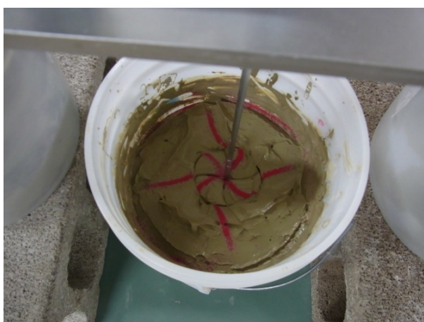
図 13 ベーンブレードを用いた場合のせん断面の様子
