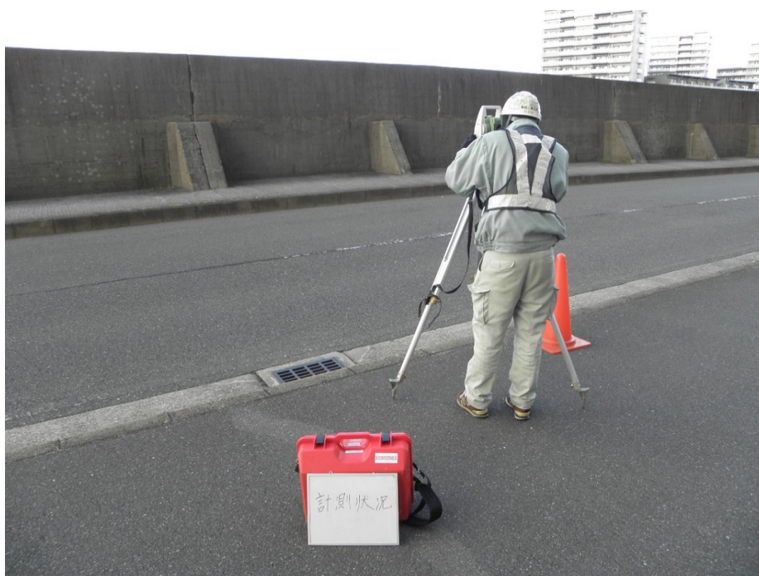
図 3-5 KUMONOS 内蔵のトータルステーションによる変状の 3 次元形状モデル計測
