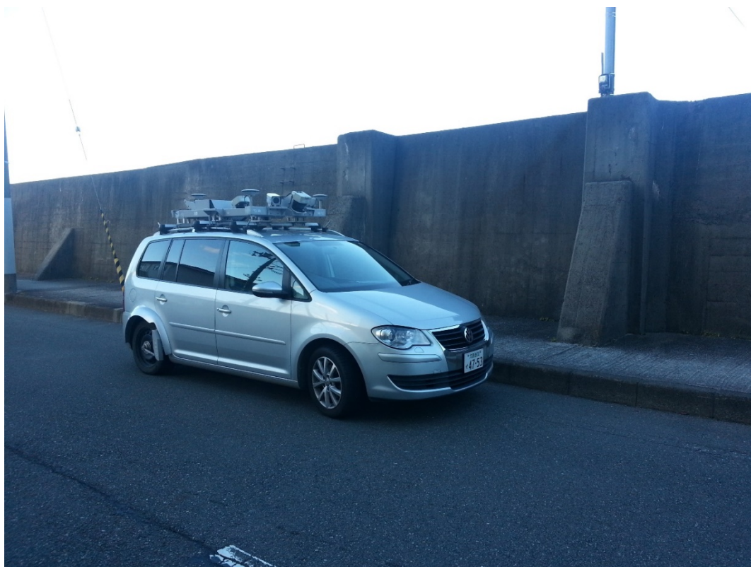
図 3-4 MMS による点群データの計測
