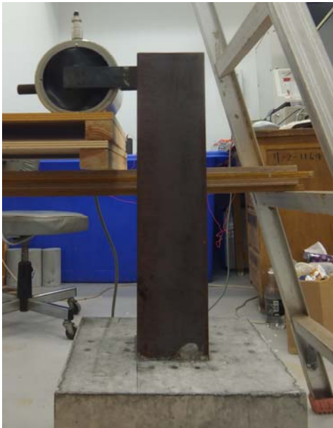
写真－2.4 H形鋼の曲げ振動試験状況
