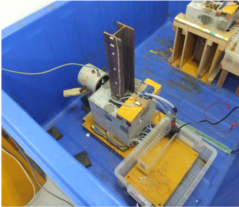
写真-2.1 電食試験の状況
