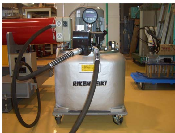
写真-15 電動ポンプ
