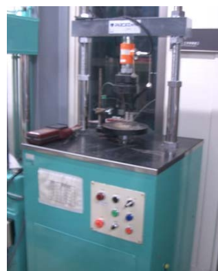
写真-14 一軸圧縮載荷装置
