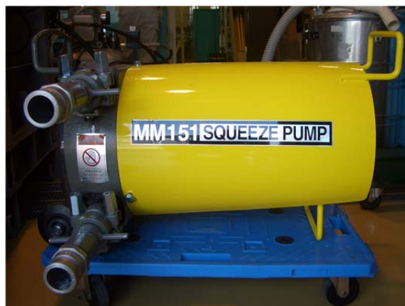
写真-17 圧送ポンプ
