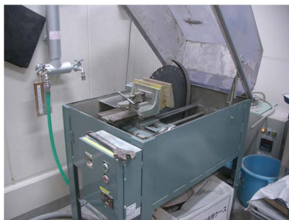
写真-19 コンクリートカッター
