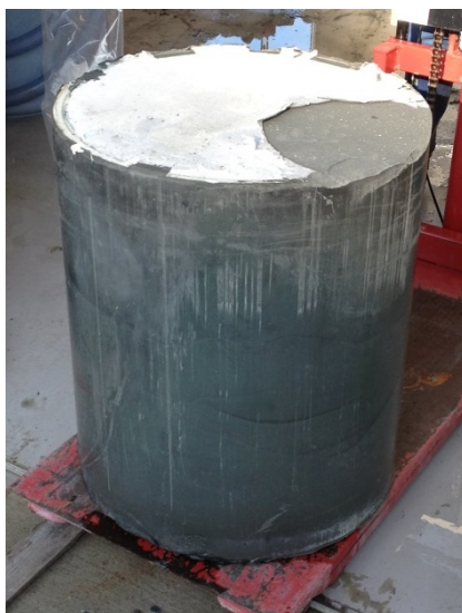
写真-21 作製した浚渫土ブロック
