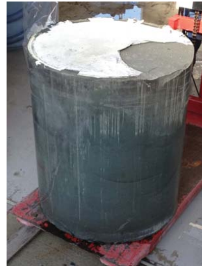
作成したスラグ石灰混合浚渫土
