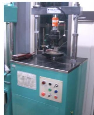
写真-8 一軸圧縮載荷装置
