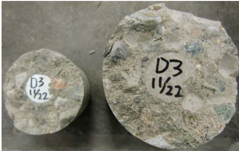
図－3（6） D 供試体の破断断面（3回目）－引張用ボルト先端
