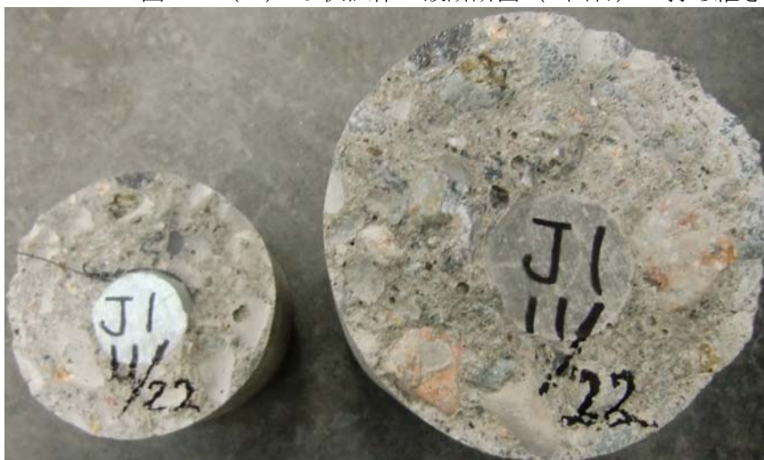
図－3（8） J 供試体の破断断面（3回目）－引張用ボルト先端
