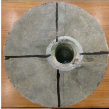
図－4 供試体載荷点の偏心
