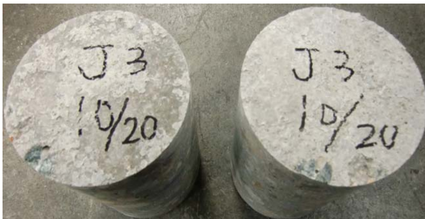
図－3（7） J 供試体の破断断面（2回目）－打ち継ぎ目
