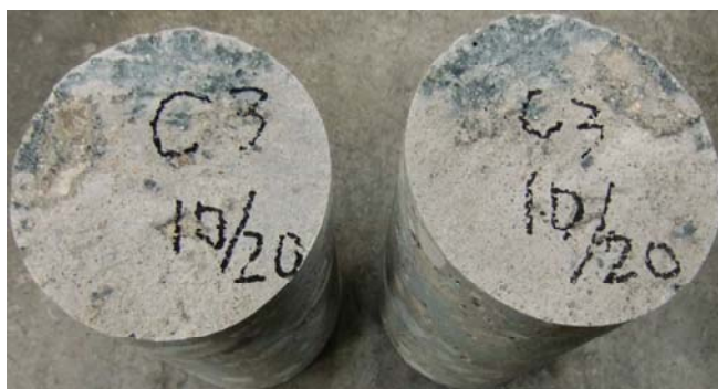
図-3（1） B 供試体の破断断面－打ち継ぎ目
