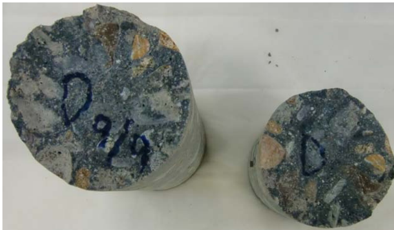
図－3（3） C 供試体の破断断面（3 回目）－引張用ボルト先端
