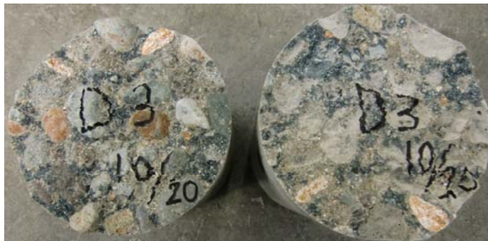
図－3（4） D 供試体の破断断面（1 回目）－母材
