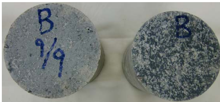
図-3（1） B 供試体の破断断面－打ち継ぎ目
