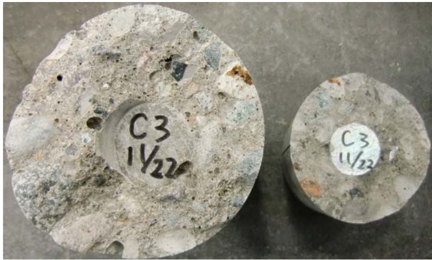
図－3（3） C 供試体の破断断面（3 回目）－引張用ボルト先端
