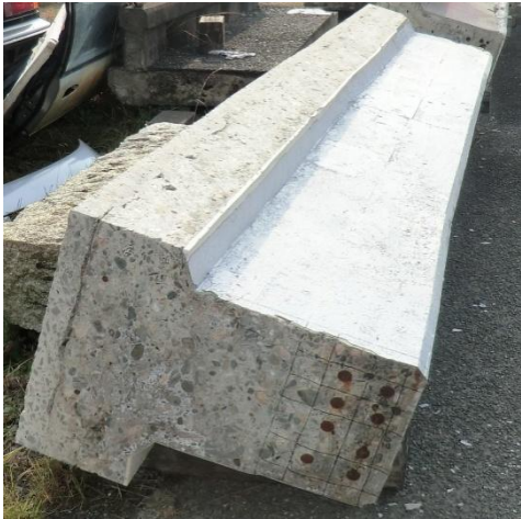
写真-4.1 K 橋から切り出した RC 部材
