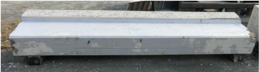
写真-4.2 K 橋から切り出した RC 部材
