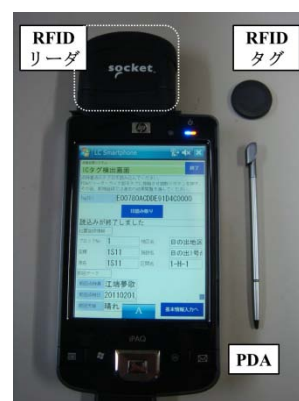
図 4.7 RFID リーダを装着した PDA と RFID タグ
