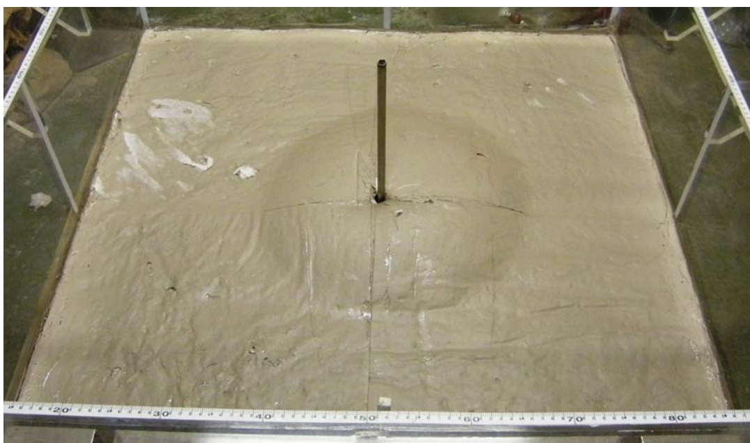
写真2.1 圧入後の中詰め粘土層表層の様子（層厚20cm①）
