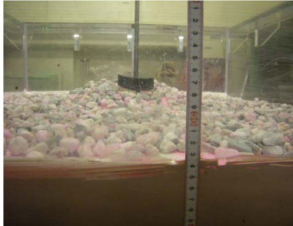
写真 3.7 改良前地盤高の様子 (重さ 360g 載荷圧 0.45\text{kN/m}^2 )
