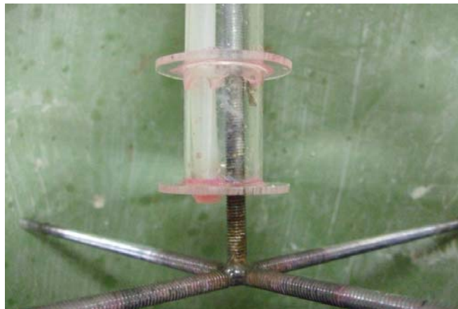
写真 3.11 圧入口に設置した攪拌棒
