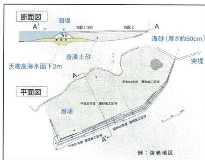
図 1.3 尾道糸崎港海老地区人工干潟の断面図と平面図 11)
