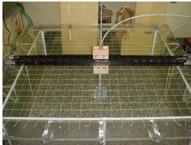
写真 3.4 固定具設置・水系を張る
