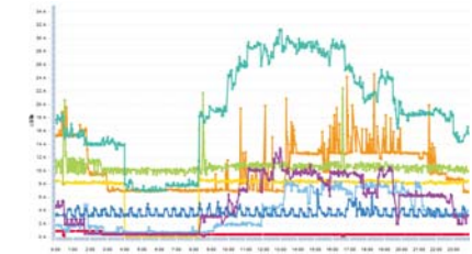
8か所の用途別電流のモニタリングデータ(24時間)
