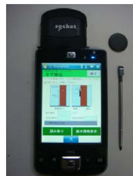
PDAにRFIDリーダーを装着した写真
