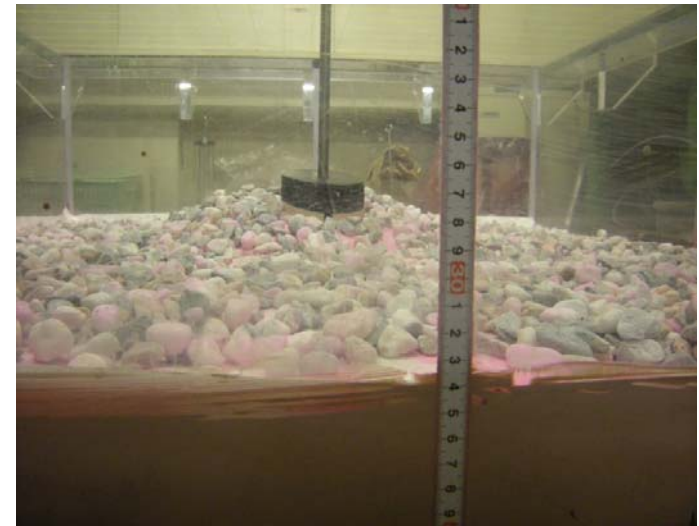
改良前地盤高の様子(重さ360g 載荷圧0.45kN/m 2 )
