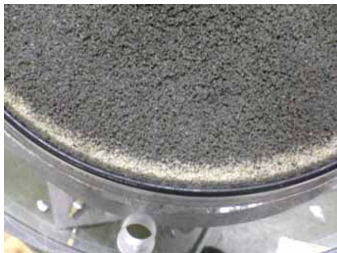
写真-3.6(b) 変動水圧载荷後の供試体（2 段目）
