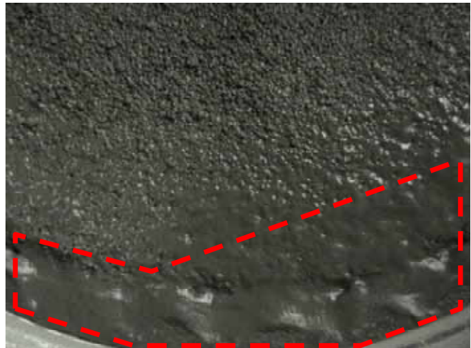
写真-3.6(a) 変動水圧载荷後の供試体（地盤表面）
