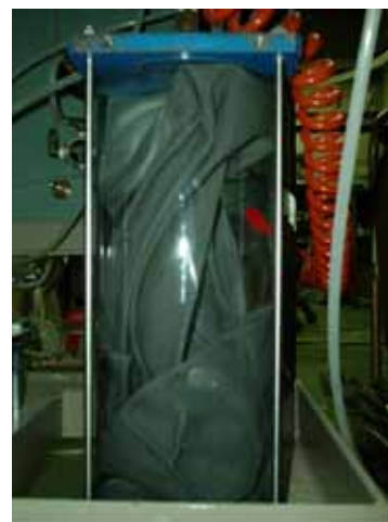
写真-3.1 空圧・水圧変換タンク
