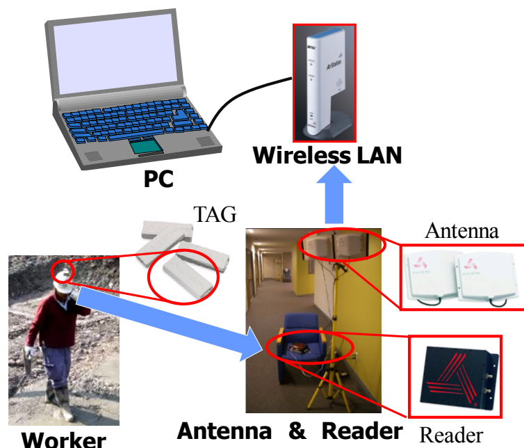
図-2.1 先行研究①で用いた機材とデータの流れ（矢印）
