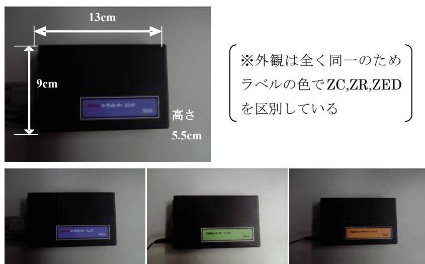
図-3.4 本研究で用いた ZigBee 装置の外観（左から ZC、ZR、ZED）
