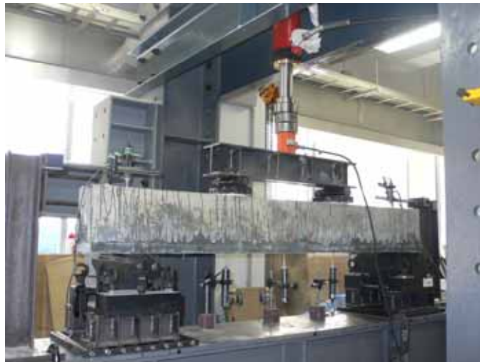
図 - 3.4 載荷試験状況（補強後供試体）
