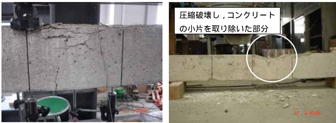
図 - 3.12 圧縮破壊部分（左図：載荷終了時，右図：コンクリート小片を除去）
