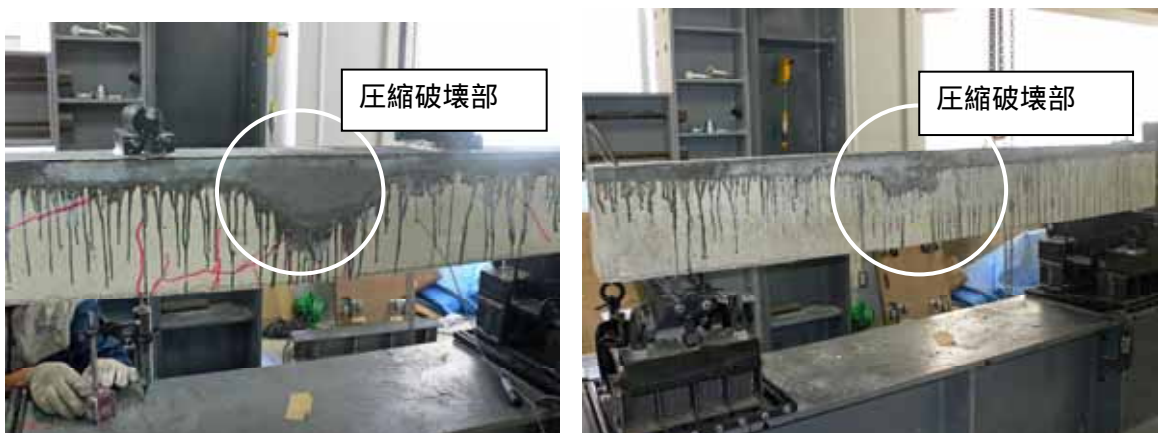
図 - 3.13 補修後の状態
