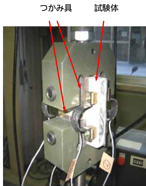
図 - 5.3 試験体取り付け状況
