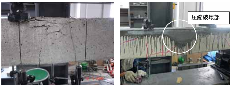
図 - 4 圧縮破壊部の補強（左図：破壊状況，右図：補強状況）
