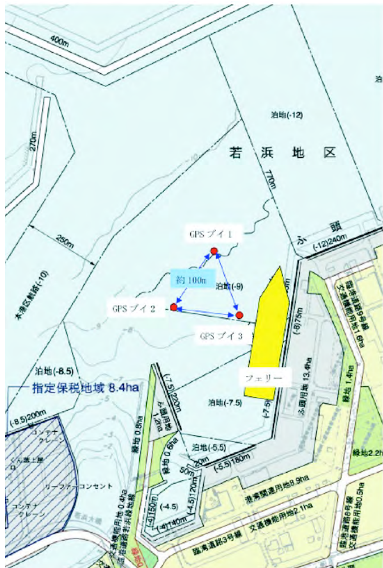
図 2: 港内係留船および付近設置ブイ配置
