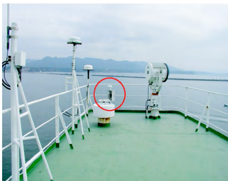
図 12: 舷側配置した GPS 受信機
