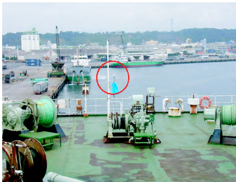
図 11: 船尾配置した GPS 受信機
