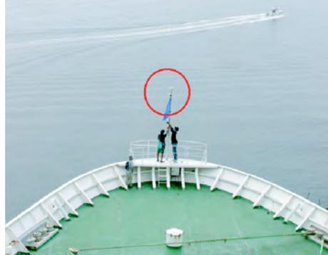
図 10: 船首配置した GPS 受信機
