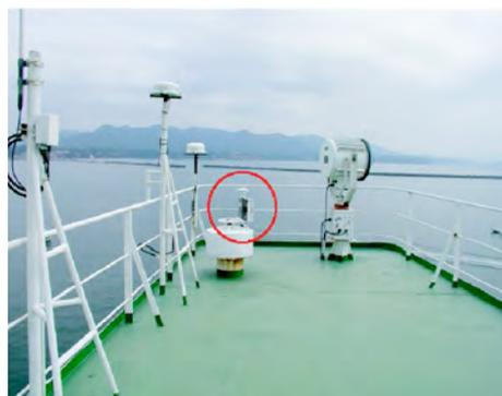
図 12: 舷側配置した GPS 受信機
