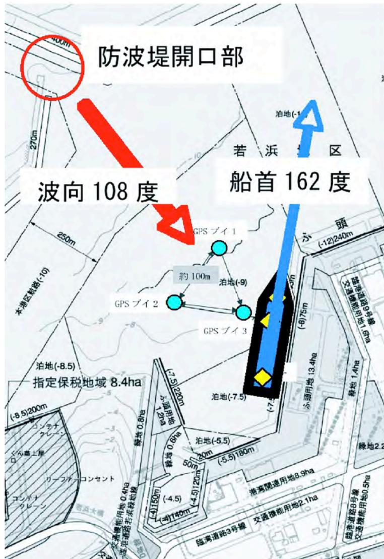
図 33: 港内防波堤, 係留船舶および波向き
