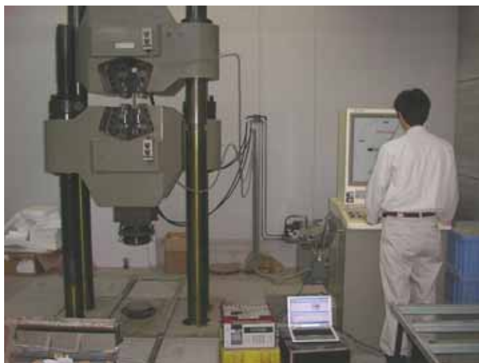
写真-3.5 鉄筋試料の引張試験状況
