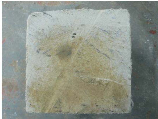
図－3.1 NaCl 溶液中で打設，硬化させた UHP-SHCC
