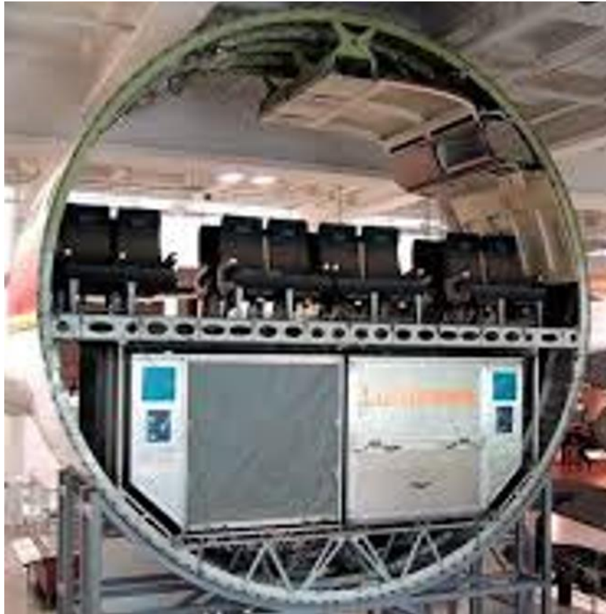
旅客機の貨物スペース (床下部)
