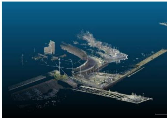
ノイズ除去前の3次元点群データ(例)
