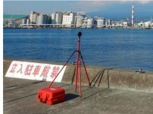
①標定点（レーザリフレクタ）の設置・観測
