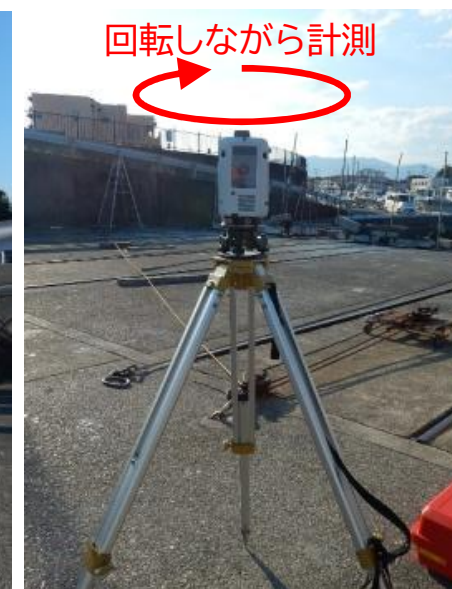
レーザスキャナ計測状況(例)
