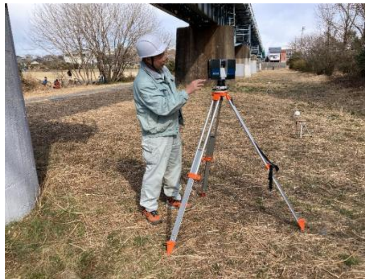
スキャナ本体の計測開始の操作状況(例)
