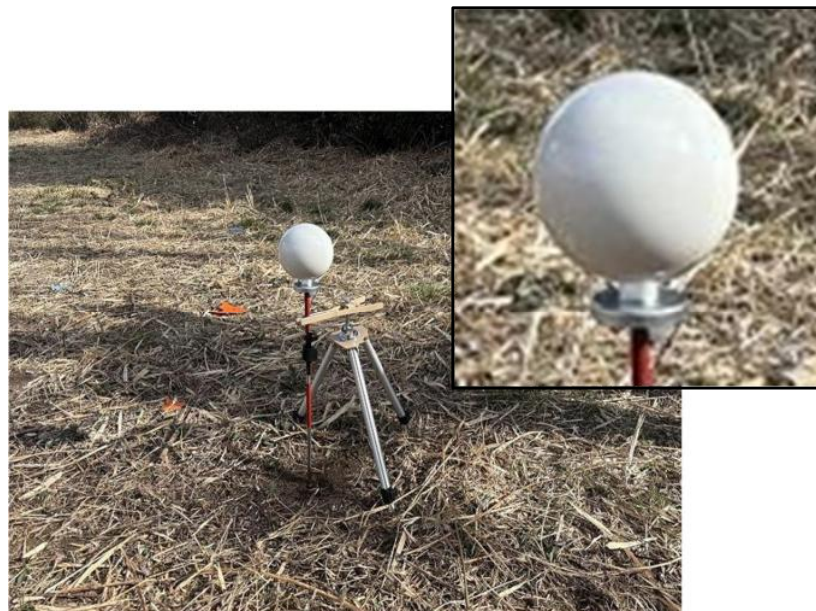
標定点(標識)の種類 球体ターゲット(スフィア)
