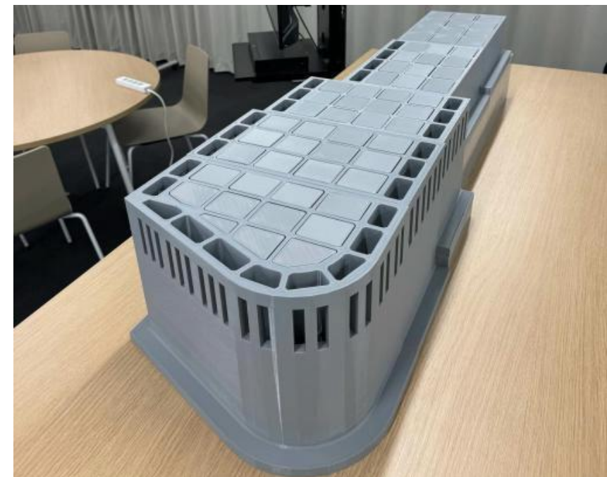
3Dプリンタによる模型(堤頭部ケーソン、配筋再現なし)
