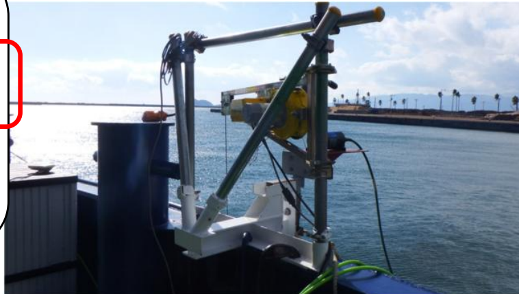
ソナーシャフト設置架台
