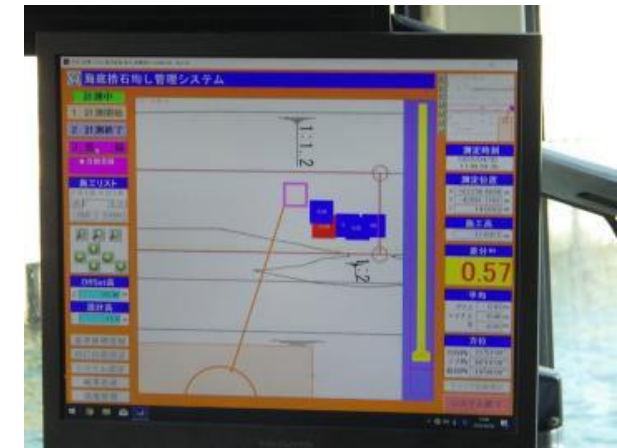
重錘施工管理システム計測状況
