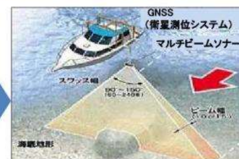
マルチビームによる出来形測量
