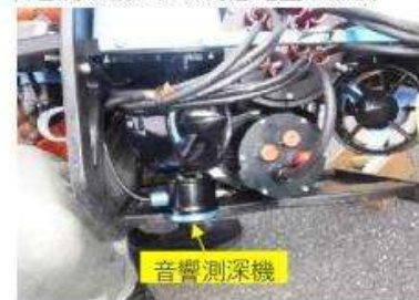
音響測深機による海底地盤の点検
