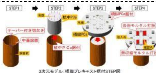
3次元モデル・橋脚プレキャスト据付STEP図
