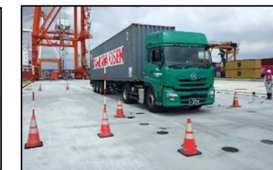
動的載荷試験実施状況
