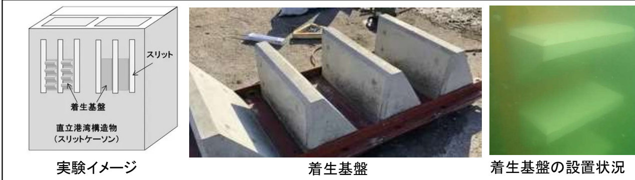
【横浜港における直立港湾構造物への海藻着生技術実証実験の様子】出典:実施者HP
