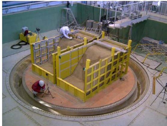
写真3-1 模型盛土全景（製作過程） 6)
